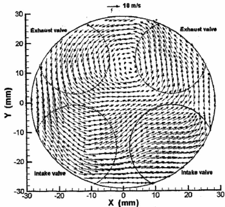
(d) Low-pass filtered velocity (in-cycle mean velocity) field
